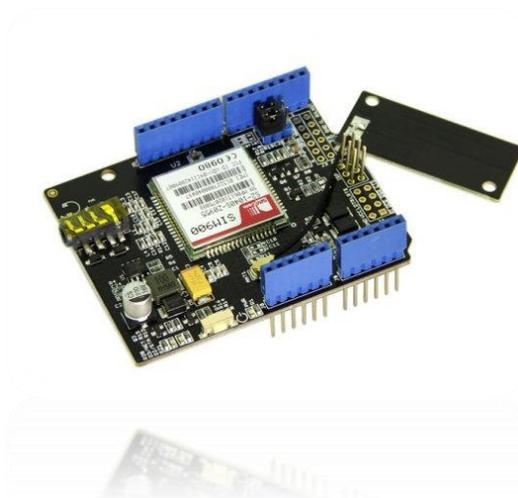
ILUSTRACIÓN 1.1.4. GPRS SHIELD V2
