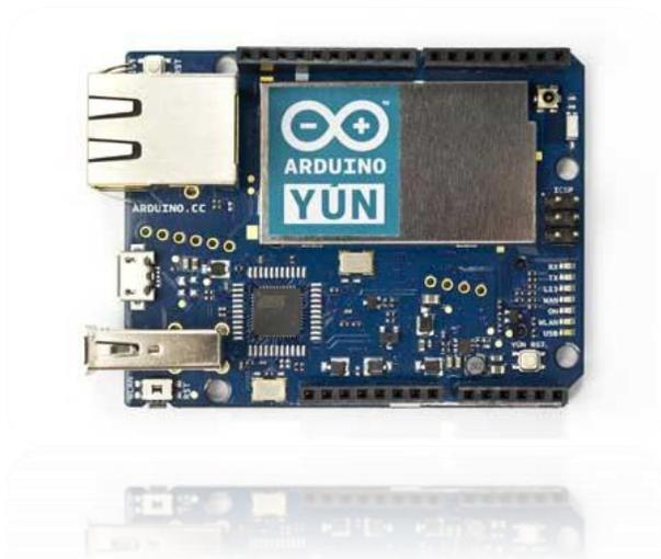
(OpenWrt-Yun) y tiene soporte para Ethernet y Wifi. Cuenta con un puerto USB, ranura de expansión para tarjetas de memoria micro-SD y además tiene 20 entradas/salidas digitales, de las cuales 12 pueden ser usadas como entradas analógicas.
